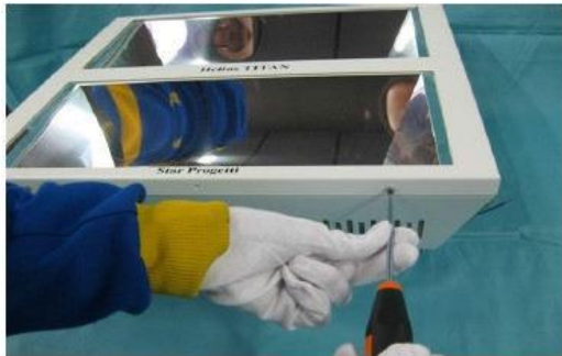
1. DEVISSER LES VIS QUI FIXENT L'ENCADREMENT
