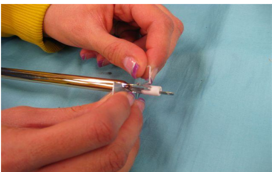
4. СНИМИТЕ С ЛАМПЫ 2 СИЛИКОНОВЫЕ ПРОКЛАДКИ, ПОКРЫВАЮЩИЕ КОНЦЫ ЛАМПЫ. ОТСОЕДИНИТЕ 2 СОЕДИНИТЕЛЬНЫХ РАЗЪЕМА ТИПА «ПАПА», ОБЕСПЕЧИВАЮЩИХ ЭЛЕКТРИЧЕСКОЕ СОЕДИНЕНИЕ.
