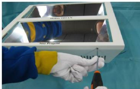
1. AFLOJAR LOS TORNILLOS QUE SUJETAN EL MARCO.
