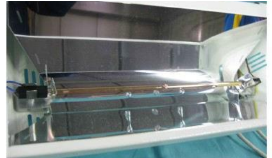
7. DIE SILIKONDICHTUNGEN IN IHRE URSPRÜNGLICHE AUFNAHME DER BEIDEN FEDERN EINSETZEN.
