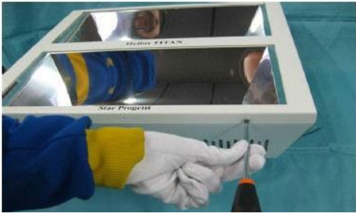
1. DIE ZWEI BEFESTIGUNGSSCHRAUBEN DES RAHMENS LÖSEN.
