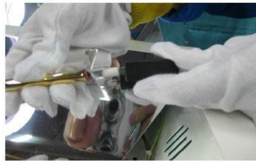
6. CONNECTER A NOUVEAU LES FASTONS SUR LA NOUVELLE LAMPE ET LA RECOUVRIR AVEC LES JOINTS SILICONIQUES.
