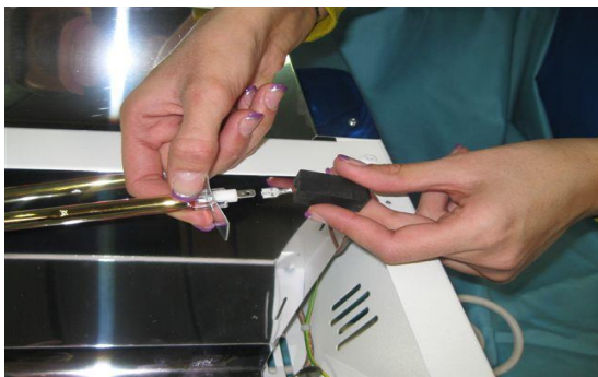
4. СНИМИТЕ С ЛАМПЫ 2 СИЛИКОНОВЫЕ ПРОКЛАДКИ, ПОКРЫВАЮЩИЕ КОНЦЫ ЛАМПЫ. ОТСОЕДИНИТЕ 2 СОЕДИНИТЕЛЬНЫХ РАЗЪЕМА ТИПА «ПАПА», ОБЕСПЕЧИВАЮЩИХ ЭЛЕКТРИЧЕСКОЕ СОЕДИНЕНИЕ.
