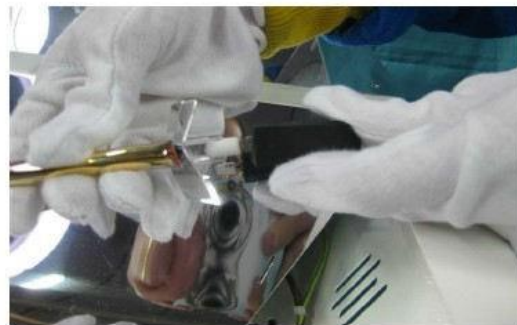
6. RICONNETTERE I FASTON SUL NUOVO BULBO E RIVESTIRLO CON LE GUARNIZIONI SILICONICHE.
