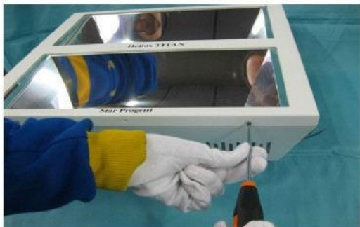
1. SVITARE LE VITI CHE TRATTENGONO LA CORNICE
