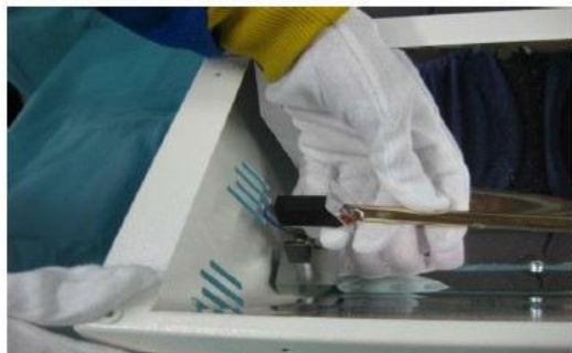
3. SBLOCCARE DALLE MOLLE DI TENUTA LE GUARNIZIONI SILICONICHE CHE RIVESTONO LE DUE ESTREMITÀ DEL BULBO
